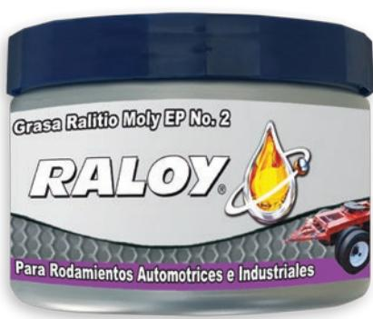
Grasa formulada con espesante a base de litio, aceite básico altamente refinado y aditivos anticorrosivos, antioxidantes, de Presión Extrema (EP) y Bisulfuro de Molibdeno para soportar altas cargas.
